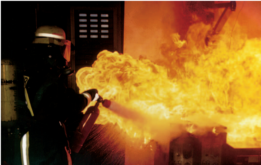
Abb. 7: Löschversuch einer brennenden Fritteuse mit einem CO 2 Löscher; ungeeignet
